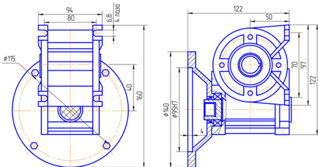
**Вариант сборки 56(возможны все варианты сборок), вариант крепления 3(4), вариант расположения червячной пары 1**
