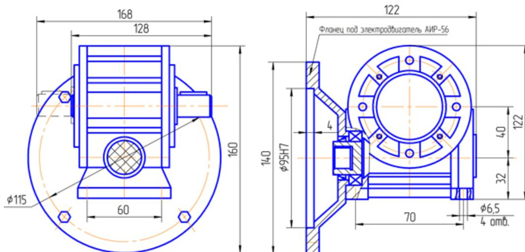
Вариант сборки 51(52,53,56,61,62,63,66), вариант крепления 1(3,4), вариант расположения червячной пары 1
