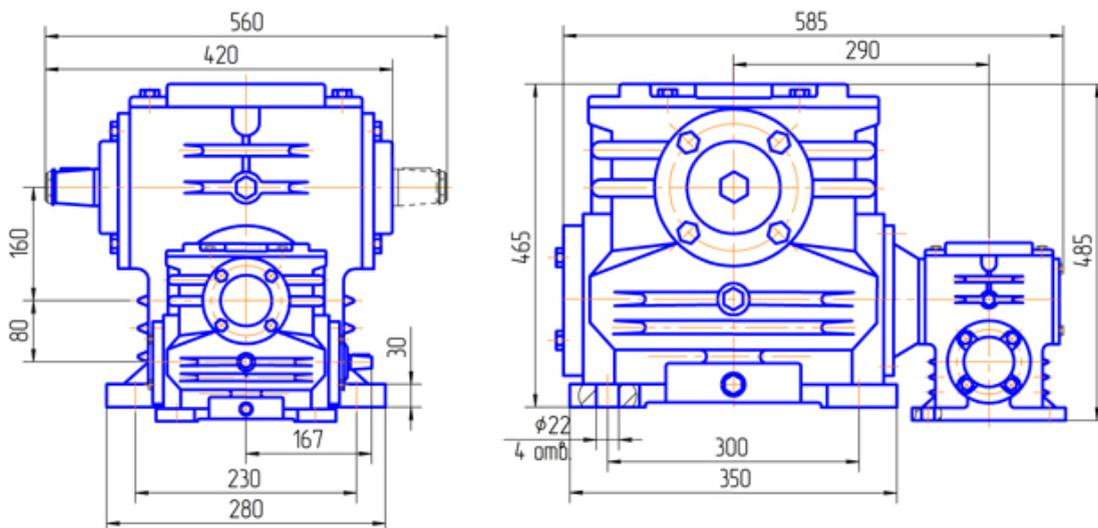
Вариант сборки 52(51,53,56,61,62,63,66), вариант крепления 1, вариант расположения червячной пары 2 ступени (тихоходной) 1, вариант расположения червячной пары 1 ступени (быстроходной) 5
