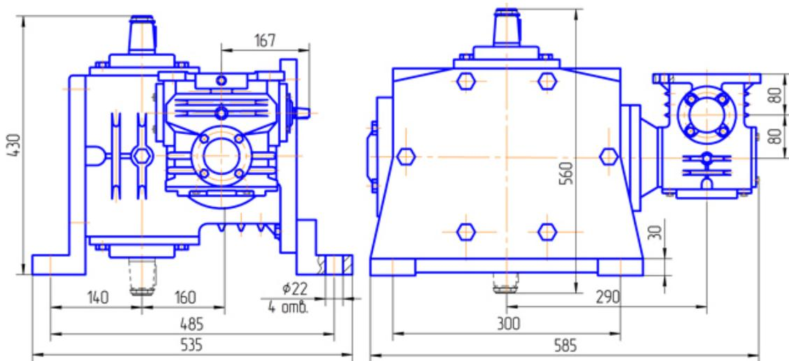
Вариант сборки 51(возможны все варианты сборки), вариант крепления 3, вариант расположения червячной пары 2 ступени (тихоходной) 4, вариант расположения червячной пары 1 ступени (быстроходной)
